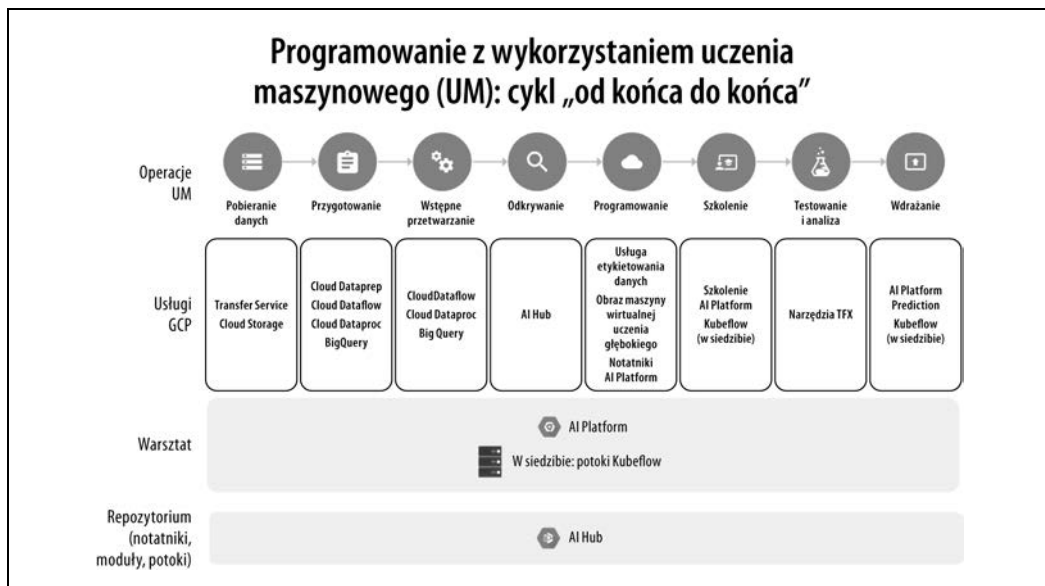
Rysunek 14.6. Platforma GCP AI
